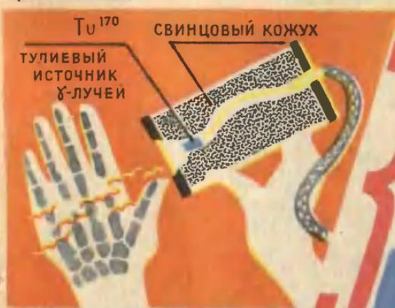
Младший брат рентгеновского аппарата — переносный тулиевый просвечивающий аппарат.
