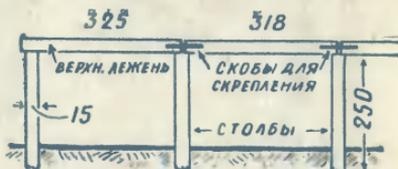
стеллажных стоек. Стеллаж устраивают над боровом на 14 стойках. Стойки, находящиеся между боровом и стеной, устанавливают до кладки борова. Их можно сделать из обрезков труб, деревянных кольев или сложить из обломков кирпичей.
